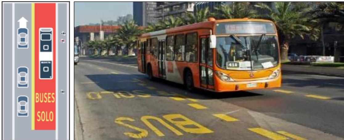
**Figura 11 - Demarcación Pista solo Bus.**
