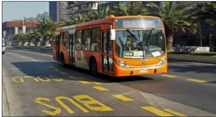
**Figura 11 - Demarcación Pista solo Bus**
