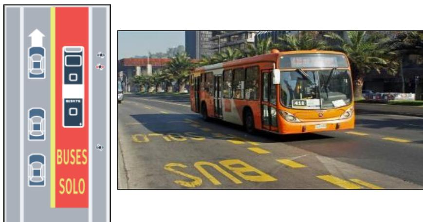
**Figura 11 - Demarcación Pista solo Bus**
